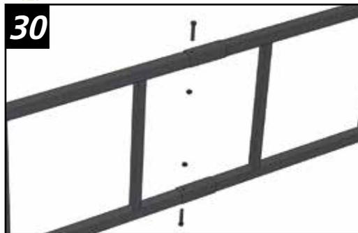
**1 3/4" BOULON, ÉCROU DE BLOCAGE - SERRER À CLÉ**
