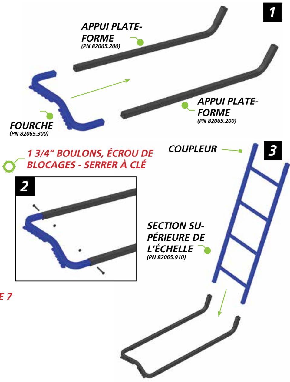
**1 3/4" BOULONS, ÉCROU DE BLOCAGES - SERRER À CLÉ**
